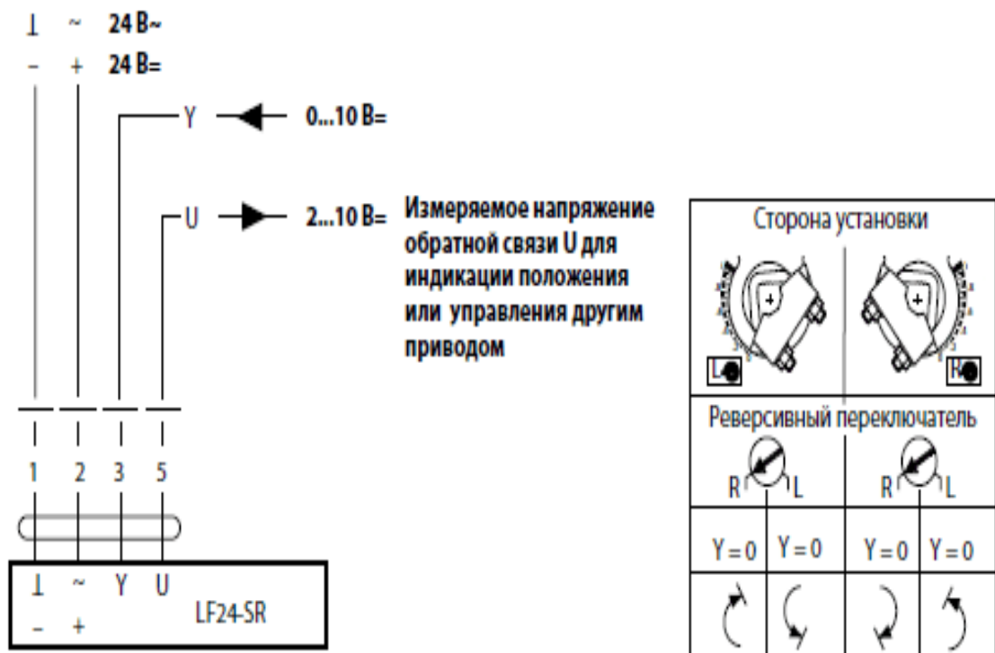
Рисунок Б.2 - Схема электричного підключення електроприводу повітряної заслінки Belimo LF24-SR
